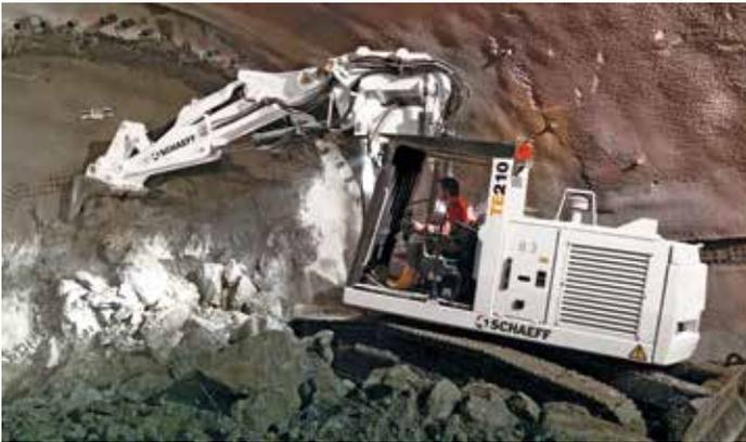
Mit seinem kompakten Aufbau ist der Schaeff TE210 besonders für den Einsatz in kleinen und mittelgroßen Querschnitten geeignet.
