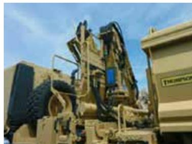
**Gefalteter 165M1 - Krane montiert auf SLDT(P)**
