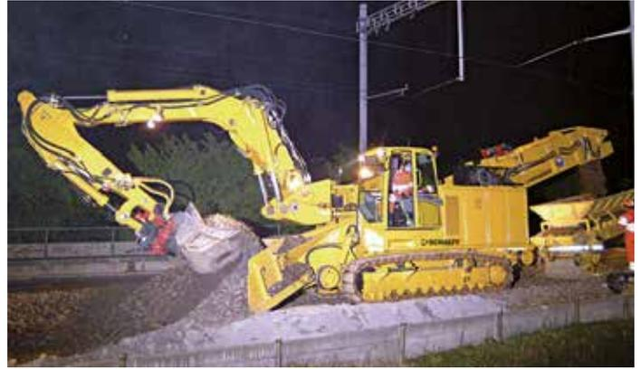
Langjährige Erfahrung in der Entwicklung von leistungsstarken Lademaschinen für die Untergrundsanierung von Bahnstrecken.
