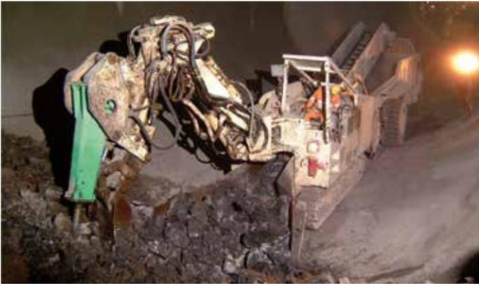
Die patentierte Hammer/Löffelkombination ermöglicht den sekundenschnellen Werkzeugwechsel. So sparen Sie Zeit und damit auch Geld
