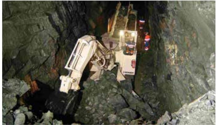
Weltweit im Einsatz, als Löse- und Lademaschinen, in weichem bis mittelhartem Gestein, als Lademaschinen im typischen Sprengvortrieb oder zum Berauben der Ortsbrust und dem Räumen der Sohle
