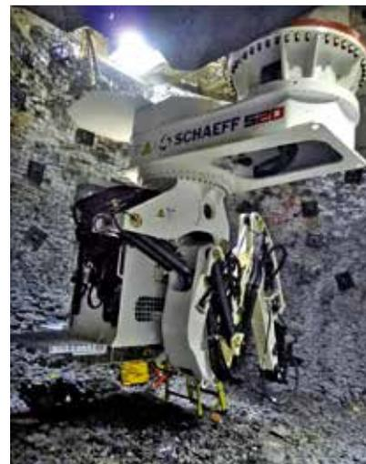
Die Baggereinheit ist ausgerüstet mit einem ersten 2x90° Schwenkwerk und einem zweiten endlos 360° drehbaren Drehwerk, um eine präzise Positionierung zum Entleeren des Löffels in den Transportkübelbereich zu ermöglichen.
