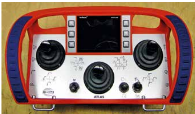
Technos 2 – mit 3 Kreuzhebel und Display – with 3 cross levers and display
