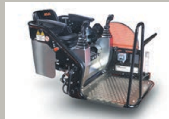
// Hydraulische Vorsteuerung inklusive ergonomisch gestalteten Komfortsitz.
